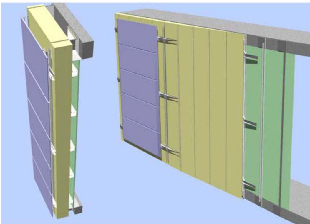
Рисунок 1. Новый тип ограждающей конструкции – термопанель
