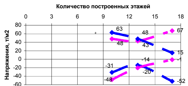
Экстремальные напряжения в сплошной кирпичной стене толщиной 640мм на 8-10 этажах (уровень 3)
