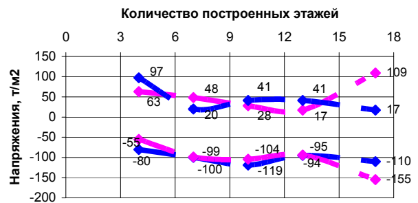
Экстремальные напряжения в сплошной кирпичной стене толщиной 640мм на 1-4 этажах (уровень 1)
