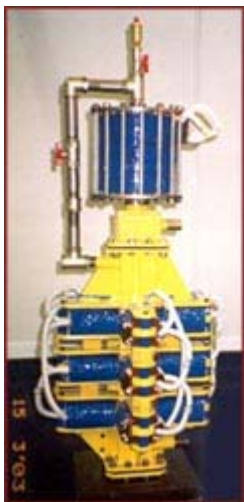
Рисунок 2. Электромагнитный активатор воды УПОВС 2-5,0 (ЗАО «МАКСМИР-М»)
