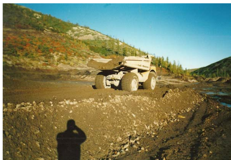
Рисунок 5. Нагружение фрагментов геомембраны перемещением по поверхности грунта груженого автосамосвала
