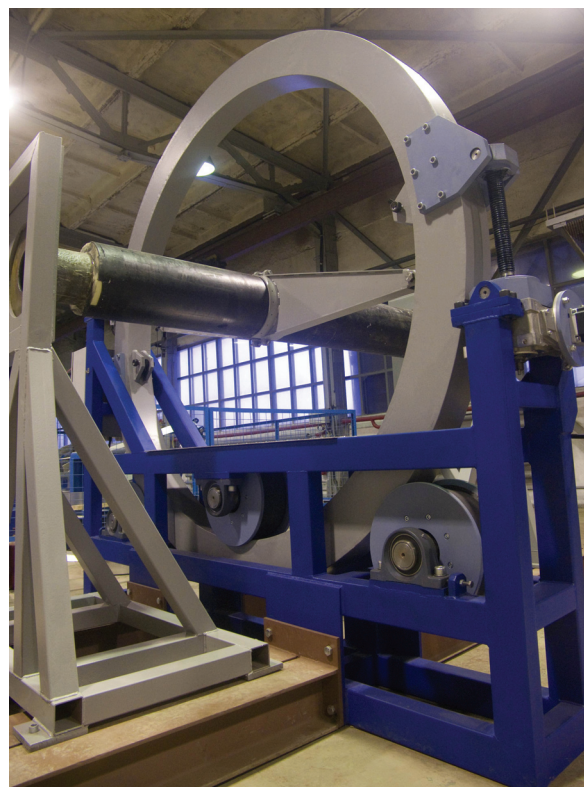
Фото 2. Установка для испытания образцов на тангенциальный сдвиг
