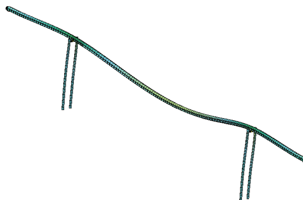
Рисунок 10. Схема деформирования балочного перехода
