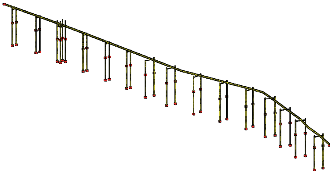
Рисунок 5. Расчетная схема надземной прокладки газопровода
