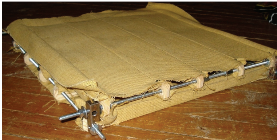
Рисунок 1. Макет текстопалубки 5000*4000*300 мм
