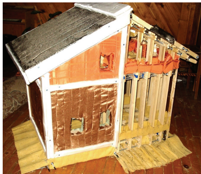
Рисунок 5. Макет пустотелого каркаса одноэтажного здания с мансардным этажом площадью 80м 2
