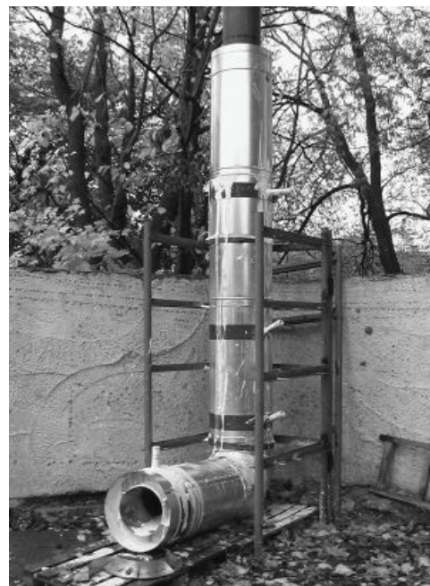
Рисунок 5. Макет углового участка трубопровода
