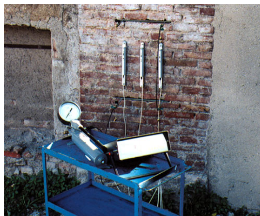
Рисунок 6. Оборудование для испытаний каменной кладки методом «Flat-Jack-Tests»: а – плоские домкраты, б – насосная станция и измерители деформаций
