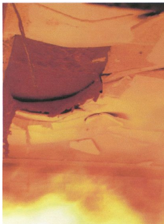
Рисунок 3. Частичное обрушение 2-го (внутреннего) слоя цементно-магнеливых плит (образец № 2, вид в смотровое окно)
