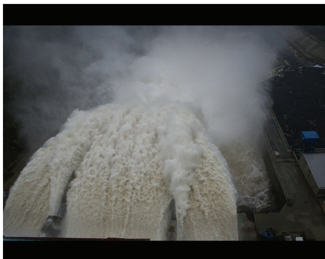
Рисунок 11. Вид сверху на поток воды при натурном испытании эксплуатационного водосброса Бурейского гидроузла (а) и тот же вид на поток при математическом моделировании (б) (М1:1)
