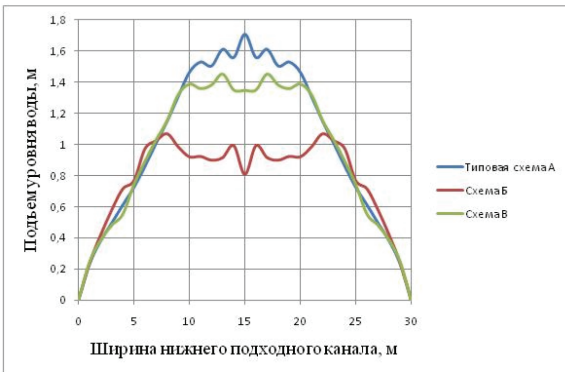
Рисунок 6. Подъем уровня воды в центральной части галереи Б
