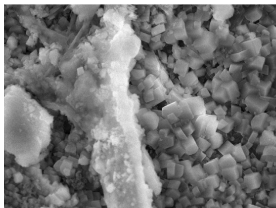
Рисунок 4. Частица продуктов высолообразования из кладки на основе вибропрессованных бетонных блоков в возрасте 11 лет при разных увеличениях
