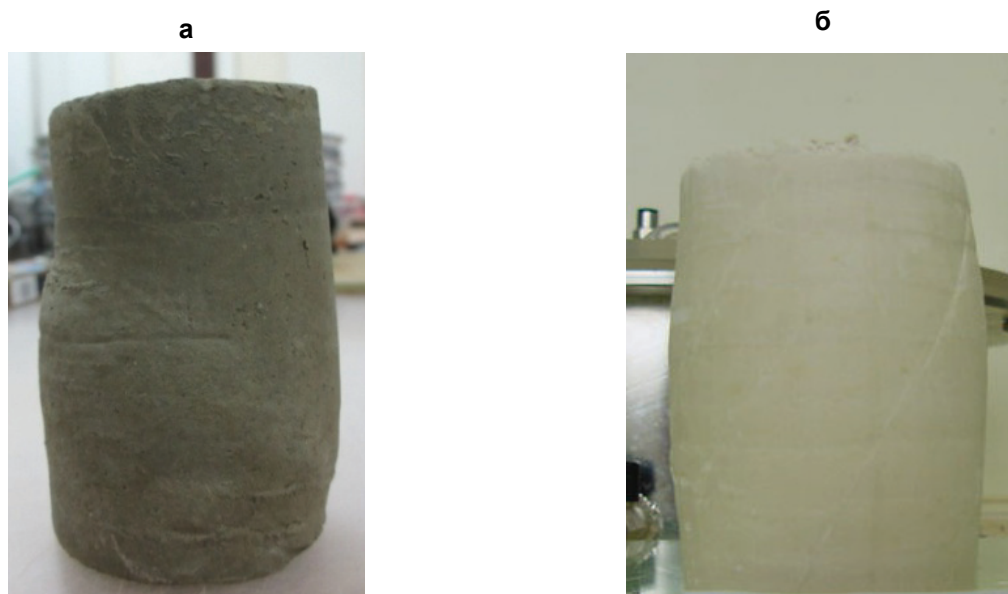
Рисунок 5: а – разрушение образцов в виде «скола»; б – в виде «бочки»
