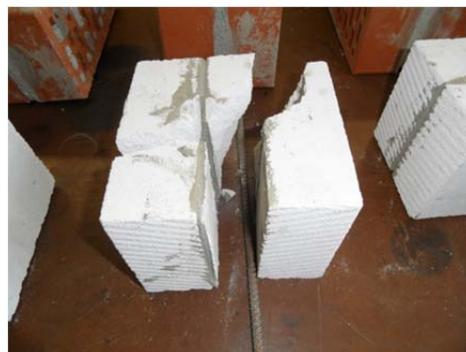
**Рисунок 7. Пример разрушения образца из газобетона**
