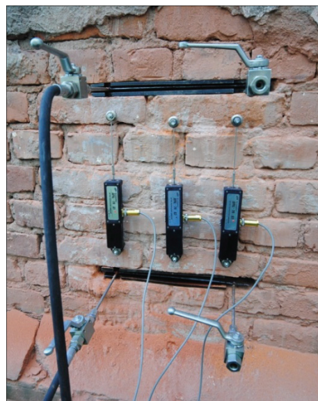
Рисунок 3. Датчики фиксации деформаций
