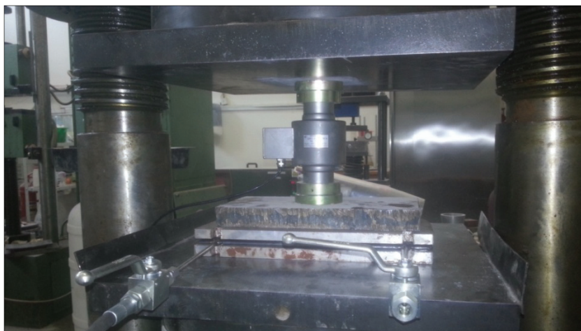
Рисунок 4. Определение жесткости домкрата
