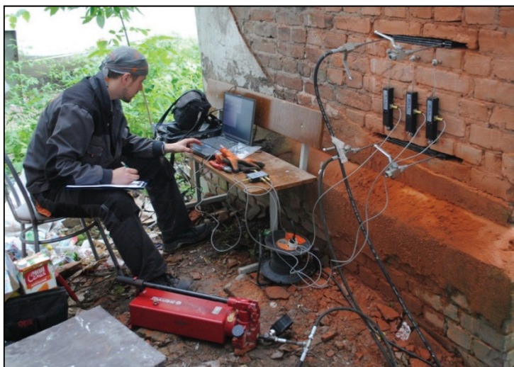
Рисунок 7. Испытание кирпичной кладки
