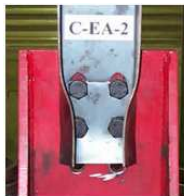
Рисунок 10. Характерный вид разрушения испытанных в [9] образцов
