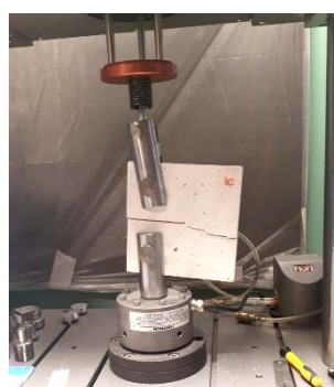
b) Tensile ultimate load determination
